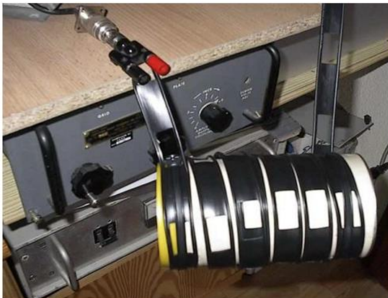
Fot. 1.1.2.2. Symetryzator z kabla płaskiego. Na zdjęciu podłączony do układu pomiarowego
