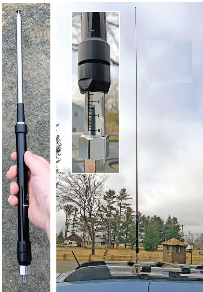
Fot. A.1. MFJ-1898 ma długość 55 cm przy całkowitym wsunięciu elementów (po lewej)
