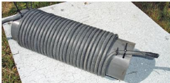
Fot. 1.2.9.2. Dławik składa się z 27 zwojów kabla koncentrycznego nawiniętego na rurce z PCW o średnicy ~11 cm
