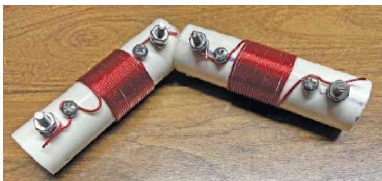
Fot. 1.2.7.3. Cewki przedłużające dla pasma 30 m przed ich zaimpregnowaniem i instalacją Fot. 1.2.7.4. Gniazdko koncentryczne jest umocowane pod skrzyżowaniem płaskowników
